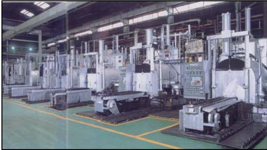
バッチ形浸炭焼入炉ライン
